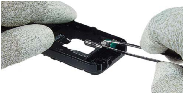
17.) Lever out the Vibra Motor .
